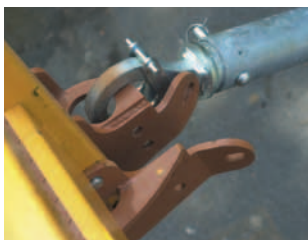
Supports de passerelle adaptés : suppression des supports d'étais et accrochage direct des étais universels
