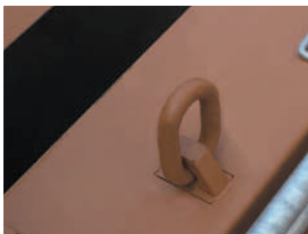
Capacité des anneaux de levage : 3,850 t.
