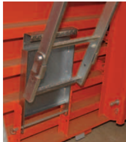
Stockage échelle sur palier
